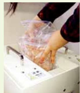
放射能測定装置(Nal(Tl)型)に食材入りの容器をセットし計測する
